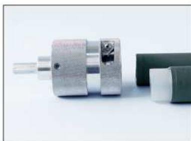
Специален инструмент за премахване на алуминиевата обвивка на тръба PN 25 Stabipipe, преди да бъде съединена чрез заваряване
