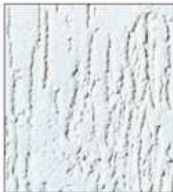
Влачена мазилка с фина структура, получена при сдринна на зърната 2 mm и изтегляне на пердашката във вертикална посока
