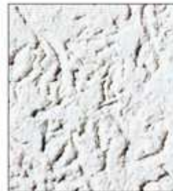
Полимерна мазилка с влачена повърхностна структура и сдринна на зърната 4 mm. Повърхността става силно релефна, а разходът на материал значително нараства
