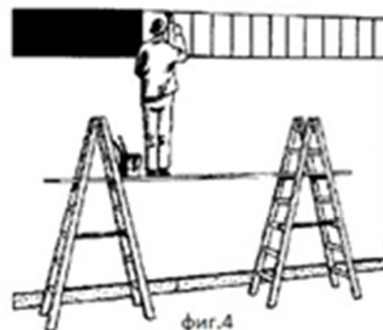
Боядисване на повърхности на височина. Двете стъпки задължително за анкерирани помежду си.
