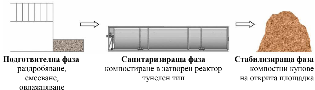
Фиг.6 Технологична схема на площадка за закрито тунелно компостиране
